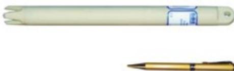
Figure 1. Capteur SBE56 utilisé par la DRM. Le stylo donne l'échelle.
