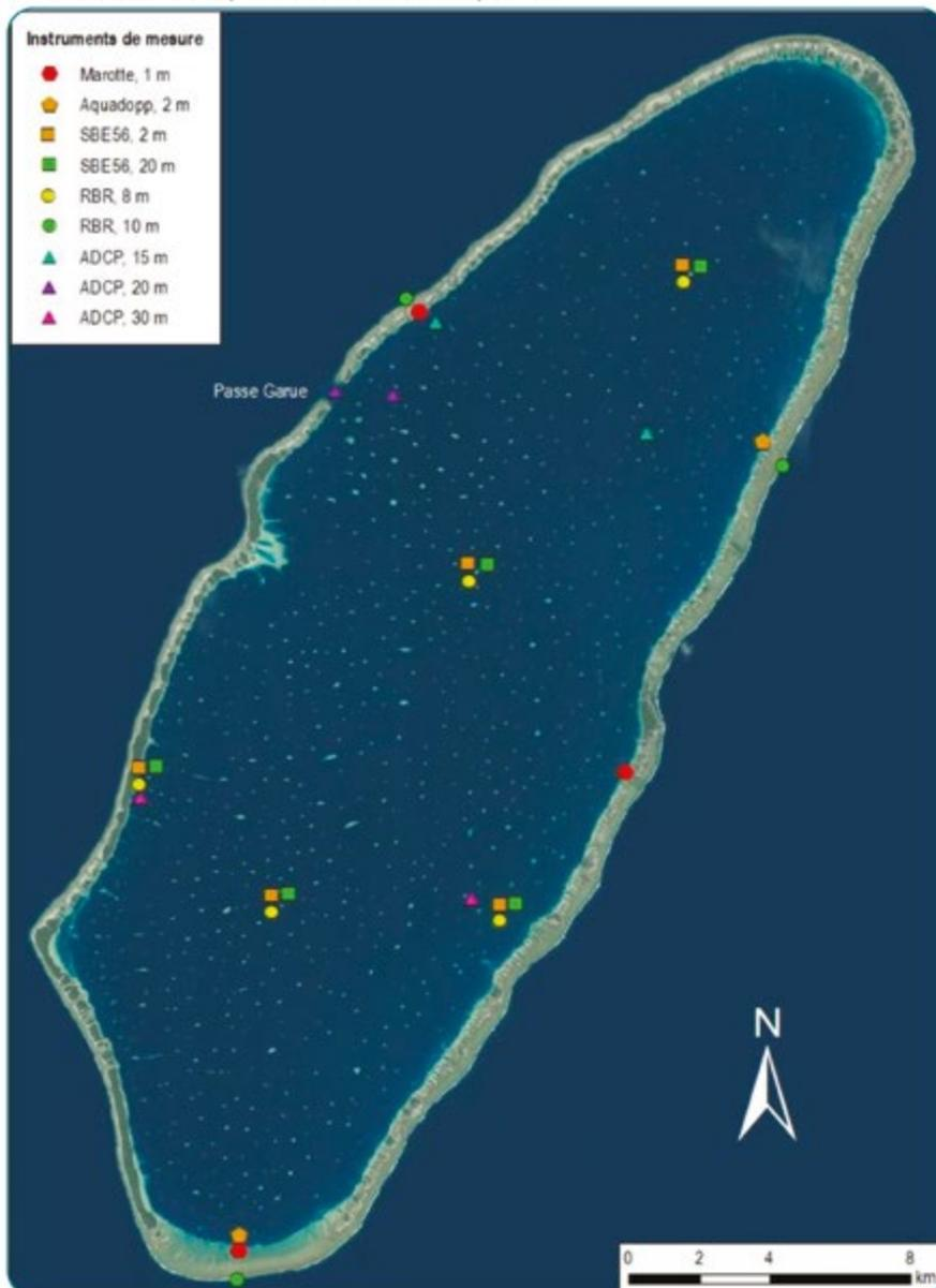
Figure 2. Emplacement du matériel qui a permis de mesurer de manière continue entre août et décembre 2018 et à haute fréquence (parfois toutes les secondes) les **processus hydrodynamiques\*** de l'atoll de Raroia.
