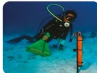
Figure 2. Pose d'un capteur SBE56. Sur le terrain, le capteur est mis en place dans un tube PVC protecteur.
