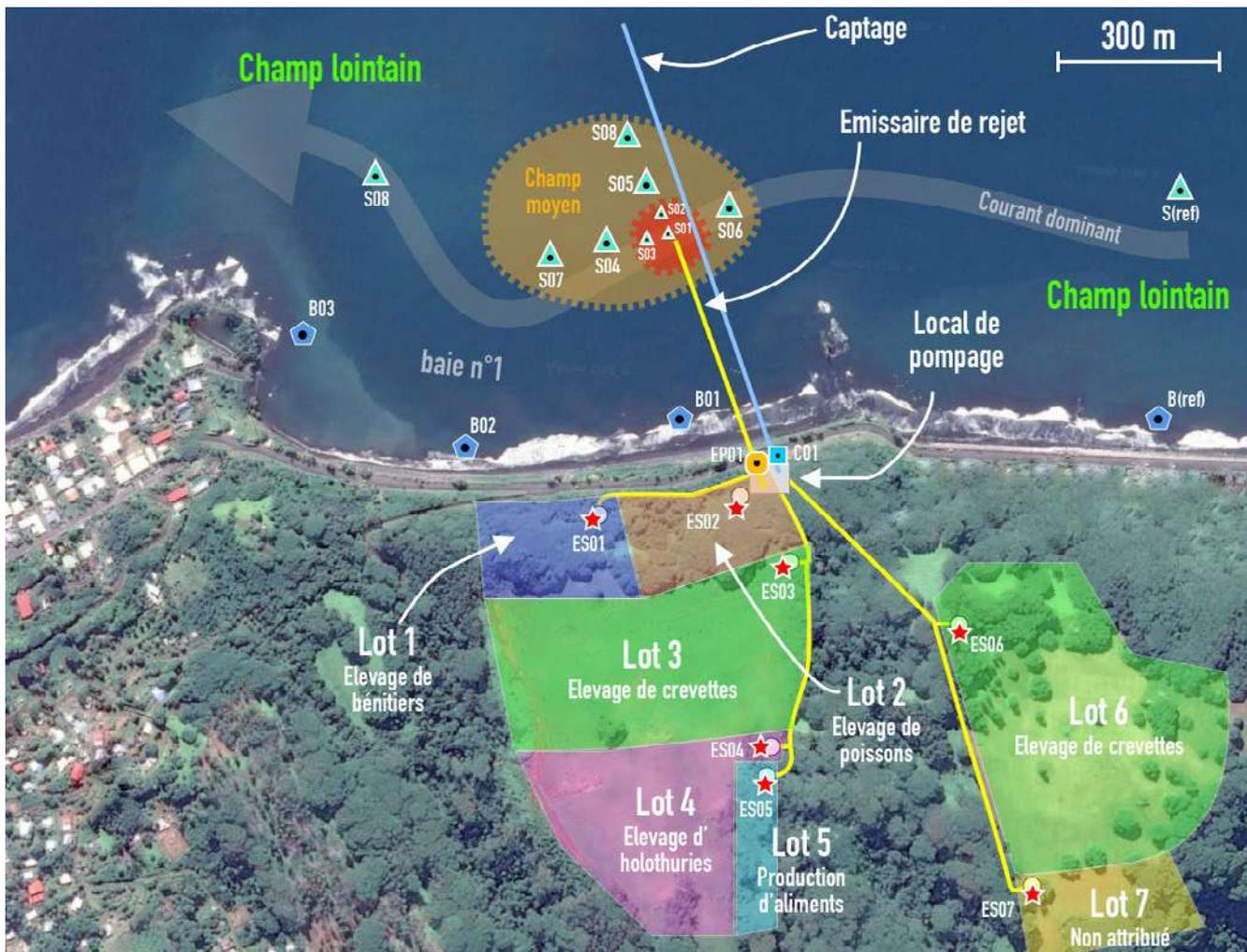
Figure 55 : Plan d'échantillonnage pour l'état initial et un programme de suivi régulier d'une exploitation aquacole avec cages en mer.
