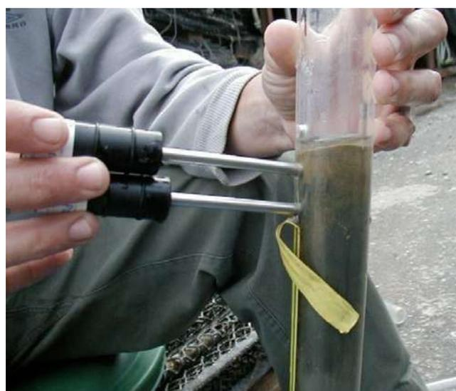
Figure 43 : Mesure du potentiel REDOX sur une carotte sédimentaire (photo tirée de Creocean 2010).
