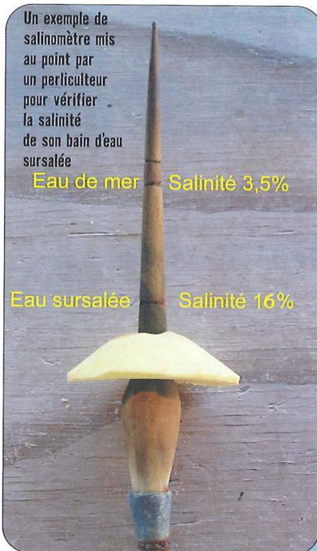
Un exemple de salinomètre mis au point par un perliculteur pour vérifier la salinité de son bain d'eau sursalée
